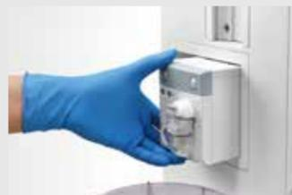
Los módulos Multi-Gas Plug-and-Play proporcionan un análisis exhaustivo de cada exhalación de O<sub>2</sub>, CO<sub>2</sub>, N<sub>2</sub>O, con detección automática de cinco agentes anestésicos, así como BIS.
